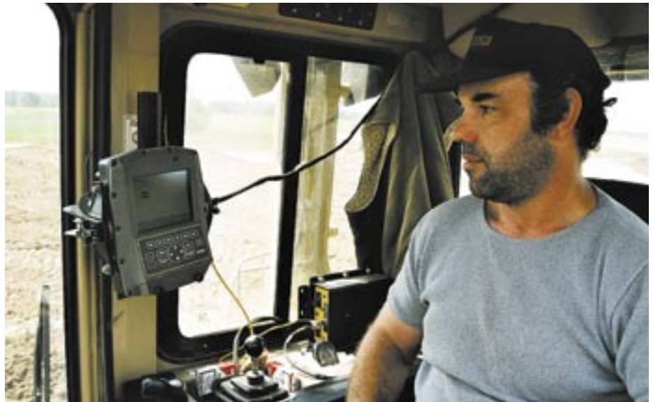
Trotz GPS-Maschinensteuerung ist es immer noch erstaunlich, wie die sanften Rundungen und Übergänge auf dem Golfplatz mit tonnenschweren Planierraupen erstellt werden können.
