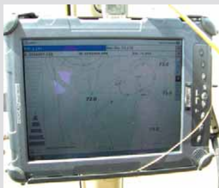
In der Kabine des Schleppers behält der Fahrer jederzeit den Überblick anhand des digitalen Geländemodells auf dem Monitor des Tablet-PCs. | Fotos: M. Jöhnk.
