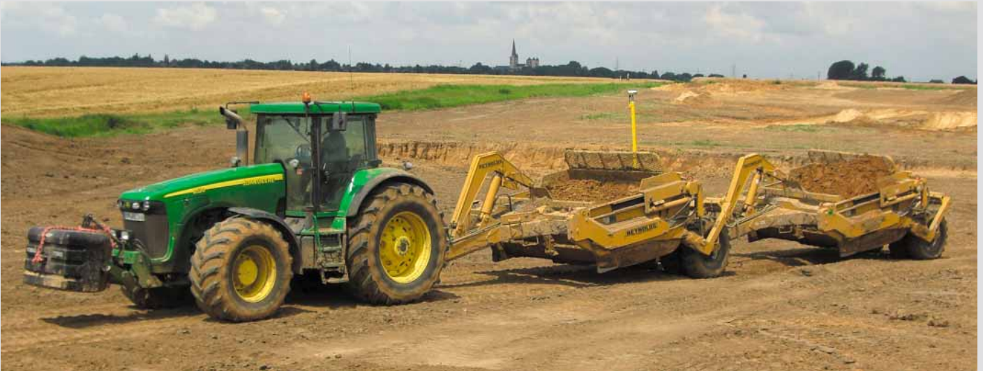
An den ersten Schürfkübel ist die Antenne mit dem GPS-Empfänger angebracht, der das Öffnen und Schließen der Kübelklappen in Kommunikation mit einer GPS-Basisstation steuert.
